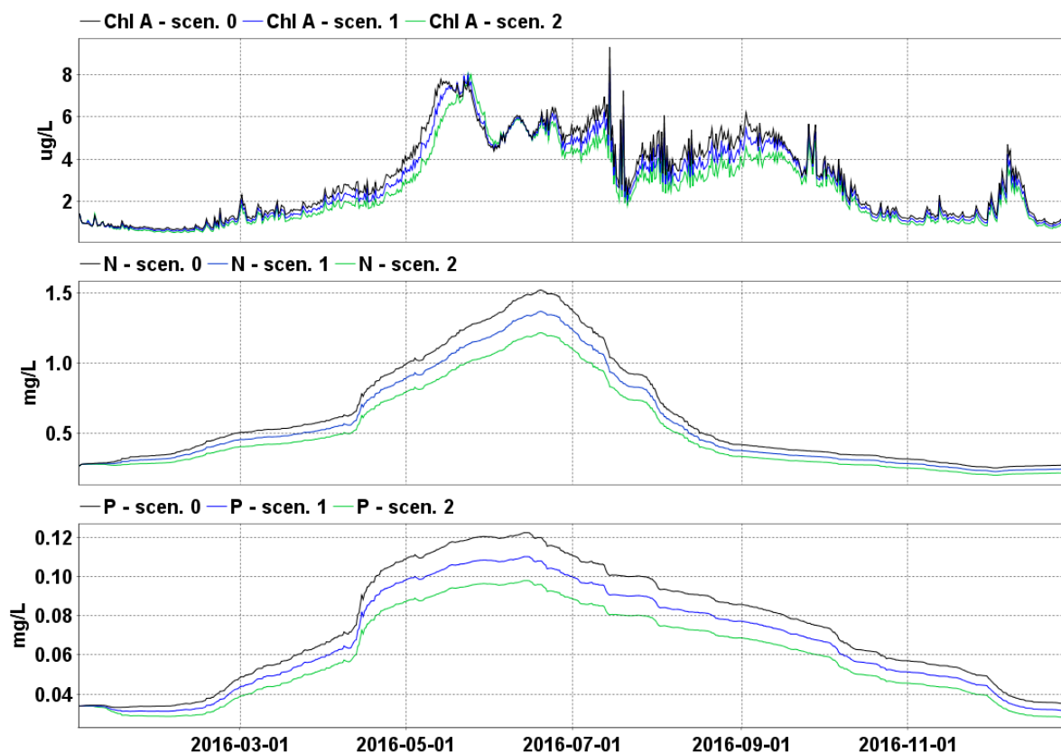
Rys. 94. Stężenie chlorofilu, azotu i fosforu na odpływie ze zbiornika dla scenariusza bazowego (scenariusz 0), dla redukcji zanieczyszczeń o 10% (scenariusz 1) oraz dla redukcji dopływu zanieczyszczeń o 20% (scenariusz 2)
